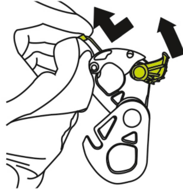
1. Zum Seileinlegen wird die bewegliche Seitenplatte aufgeklappt und gegebenenfalls der Klemmnocken über den Arretiermechanismus offen gehalten.
