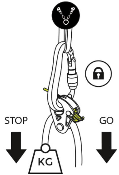
2. LINKS: Verwendung als Aufstiegshilfe: Das Gerät gemäß der Abbildung einlegen. Es ist sicherzustellen, dass das Gerät in die gewünschte Richtung blockiert und der Karabiner verriegelt ist.
