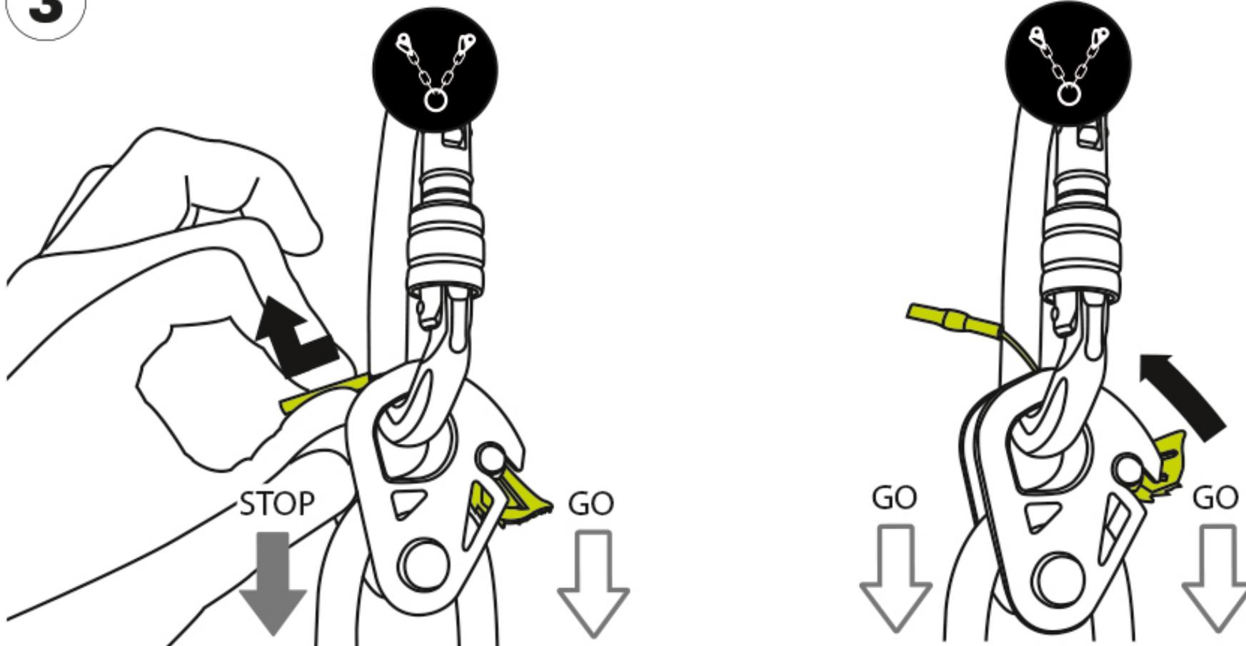
3. Bei der Verwendung des Geräts als Rolle mit Rücklaufsperre lässt sich über den Arretierungsmechanismus die Klemmwirkung aufheben, sodass das Gerät nur noch als Umlenkrolle funktioniert.
